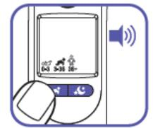
4. 閒置 3 秒後，所顯示的標誌會在顯示幕上固定顯示，耳溫槍發出一聲長鳴，然後關機。重新開機時，預設值便已完成設置。
